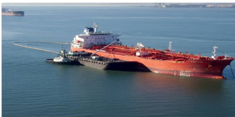
Figura 1 - Operação de abastecimento em fundeadouro entre embarcações (*Bunkering*).
