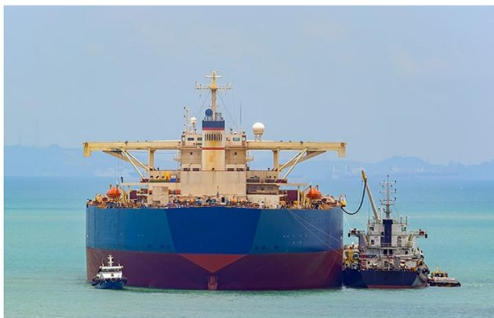
Figura 2 - Operação de abastecimento em fundeadouro entre navios (*Bunkering*).
