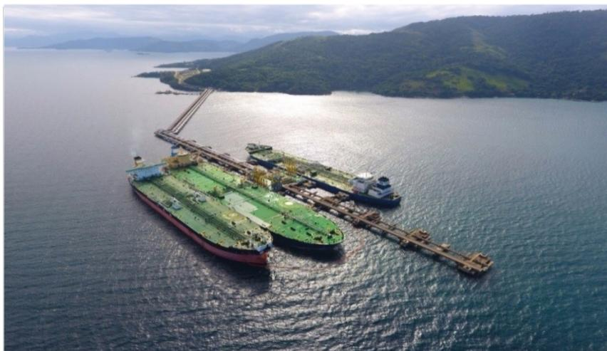
Figura 3 - Operação STS atracado em instalação portuária (*double banking*).
