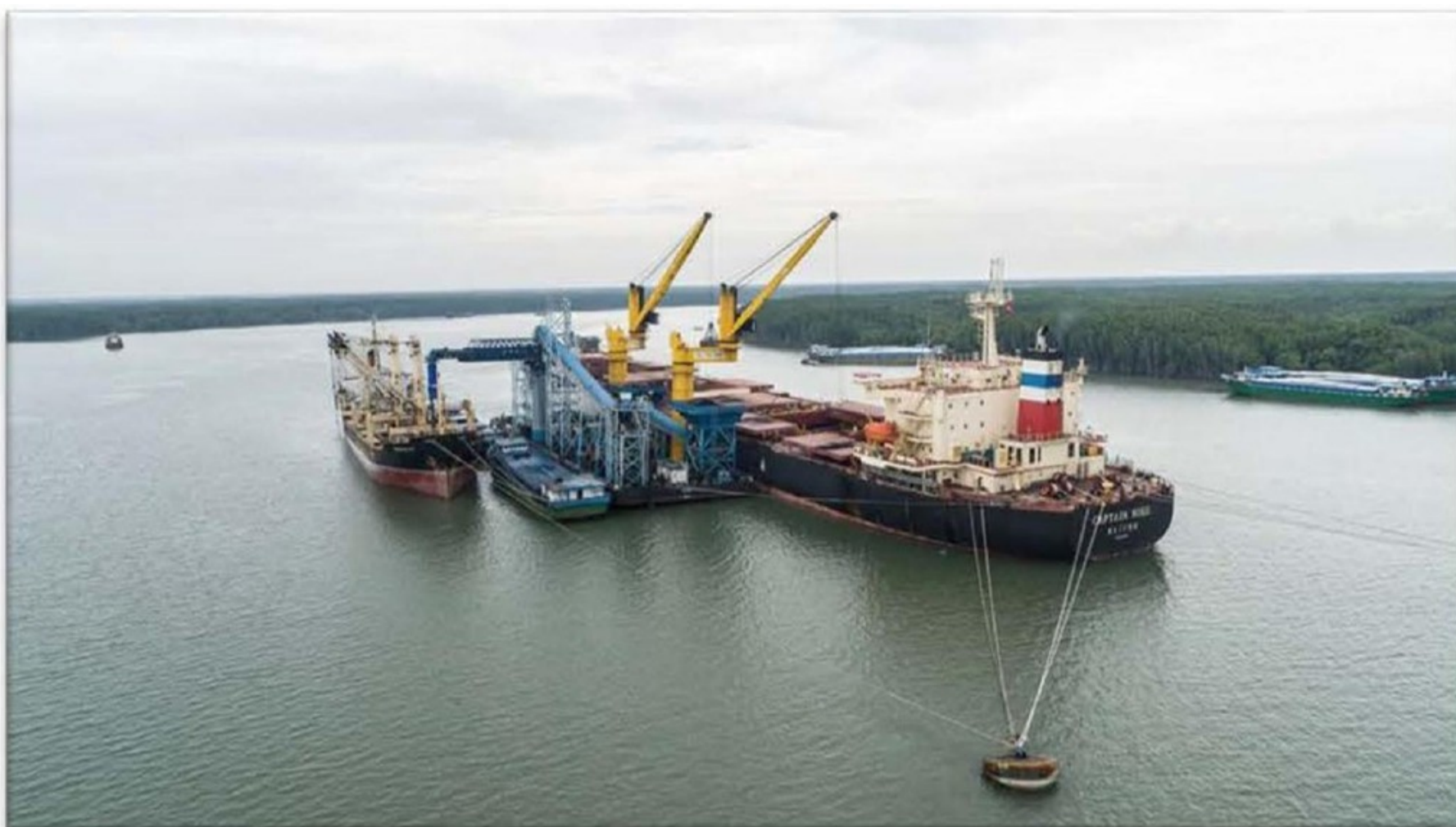
Figura 7 - Operação de transbordo com os navios amarrados em sistema de boias.
