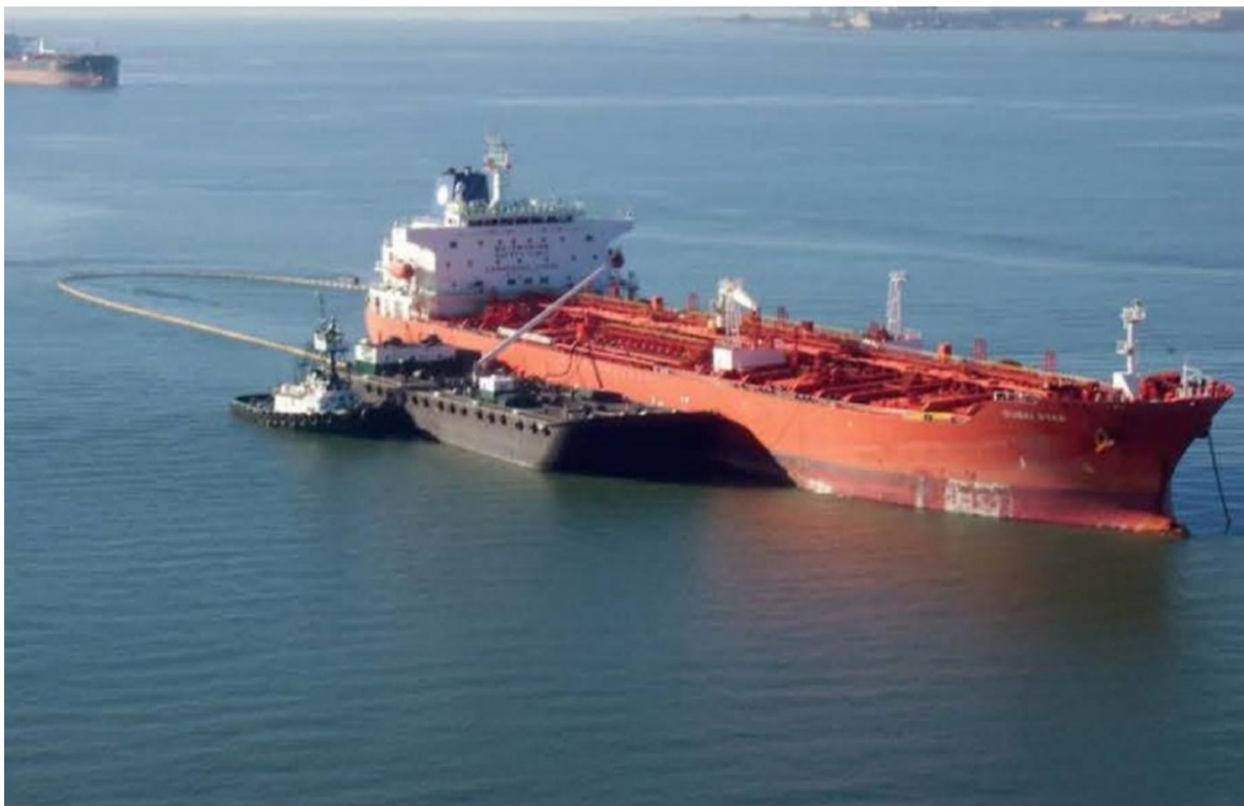
Figura 1 - Operação de abastecimento em fundeadouro (Bunkering).
